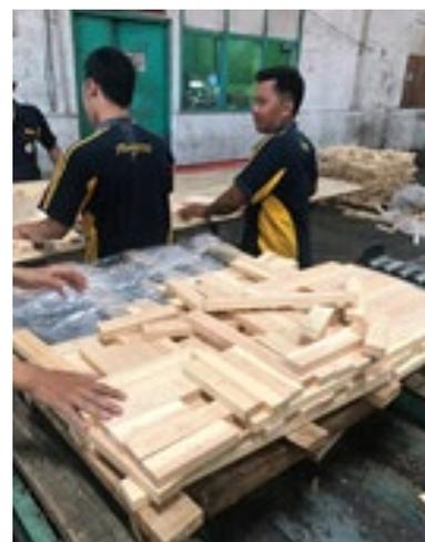
指定された製品の長さにラミナをつなぎ1層棒を作ります。同じ長さが揃わない様にバラバラにして機械に入れると両木口がギザギザにカットされた後に接着し、1本につながって1層棒となり出てきます。
