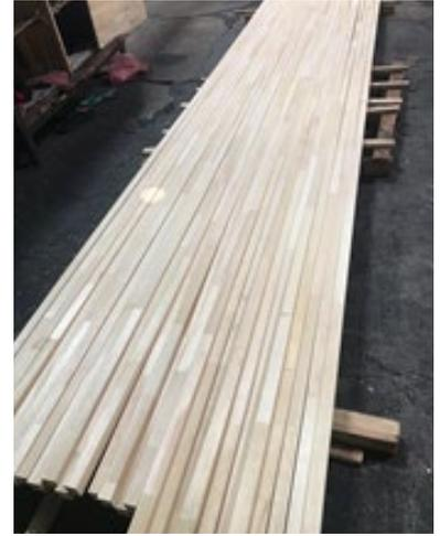
S4Sになった1層棒を横ハギ機に横に並べ、指定された巾(500,600など)に圧力をかけて接着します。接着剤が乾き横ハギが完了し、しばらく養生させてからワイドサンダーを使い、はみ出した接着剤を削り取り、さらに目の細かいサンダーで最終厚みに仕上げます。
