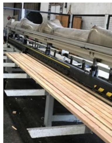
次にラフ材の1層棒をモルダー加工しS4S(4面プレーナー)材にします。
