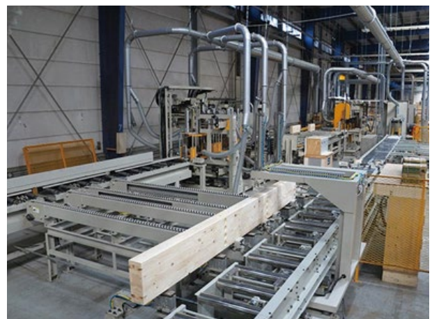
金物工法加工ライン
