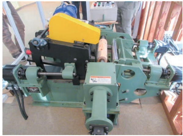
ロータリーベニヤレースを実演していただきました。最後わずかな芯しか残りません。
